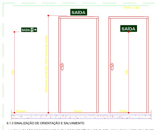
a) A SINALIZAÇÃO DE PORTAS DE SAÍDA DE EMERGÊNCIA DEVE SER LOCALIZADA IMEDIATAMENTE ACIMA DAS PORTAS, NO MÁXIMO A 0,10 M DA VERGA; OU NA IMPOSSIBILIDADE DESTA, DIRETAMENTE NA FOLHA DA PORTA, CENTRALIZADA A UMA ALTURA DE 1,80 M, MEDIDA DO PISO ACABADO À BASE DA SINALIZAÇÃO.
